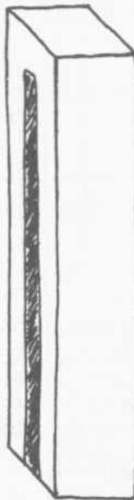
SLOT HASN'T BEEN SAW COMPLETELY FOR THE HANDLE HOLES CAN BE MATCHED IN THE STEEL EASIER.
